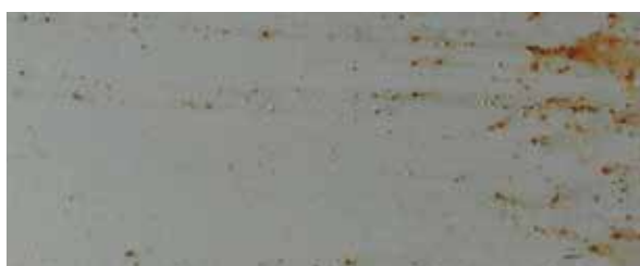
▲ 2液溶剤型防錆塗料を1回塗布した試験鉄板
