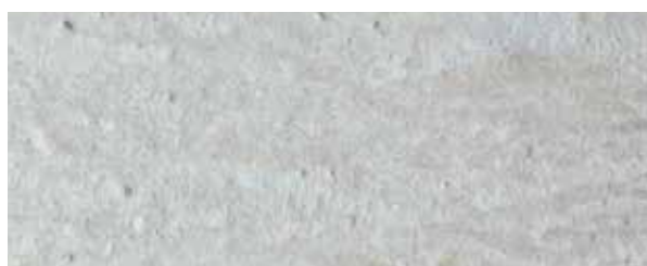
▲ 2LPコートを1回塗布した試験鉄板
