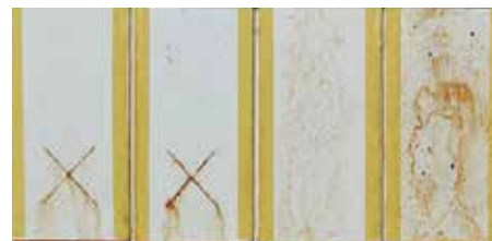
▲ 市販防錆塗料の実験結果
